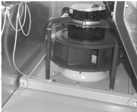
18. ábra - A ventilátor kilövési eljárása
